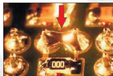
Перемычки при пайке волной припоя
