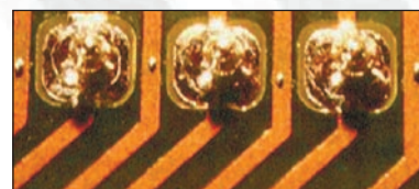
Образование шариков при пайке волной припоя
